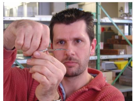
Erst danach wird die Schere von den Mitarbeitern final geschliffen und so lange überprüft, bis sie wirklich den strengen Qualitätsmerkmalen gerecht wird. Anschließend werden die Oberflächen geputzt und letztmalig kontrolliert. Wichtig ist, dass die Schere bis zum letzten Millimeter der Spitze hin sauber schneidet. Das wird in der Endkontrolle bei jeder Schere von Hand zusätzlich geprüft.
